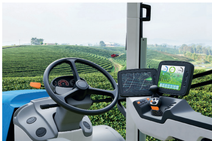
Bild 1. Isobus gör det möjligt att plug-and-play-integrera sensorer och redskap från olika tillverkare.
